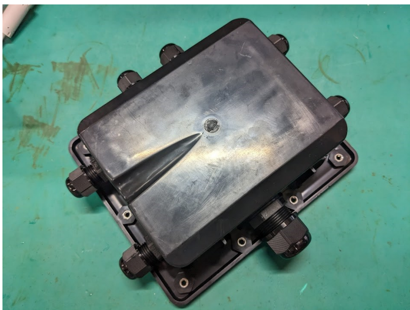
図 4-6 防水ボックスの完成
