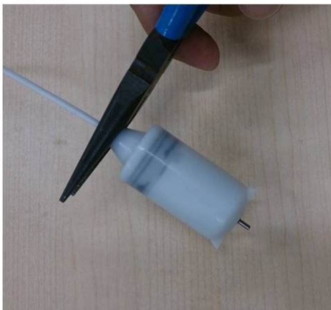
図 4-9 ケーブルの取り外し
