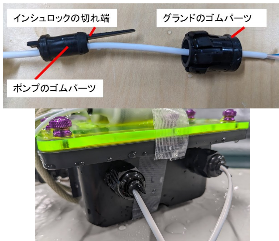
図4-9 灯油ポンプのゴムパーツにインシュロックを通してグラントに入れる
