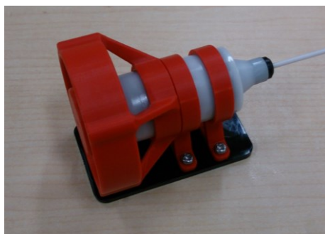
図 4-20 スラストの組み上げ
