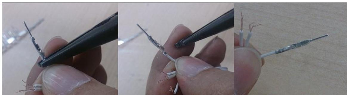
図 5-12 配線材に端子を圧着する
