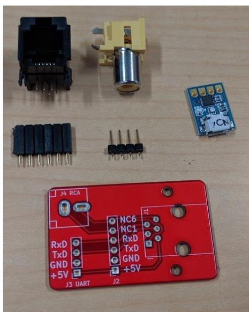
図 5-11 テザー基板に必要な部品
