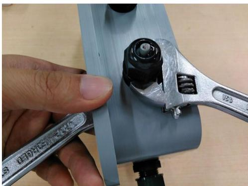
図 4-5 レンチによる締め上げ
